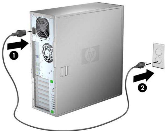
Obrázek 3-3 Připojte napájecí kabel
