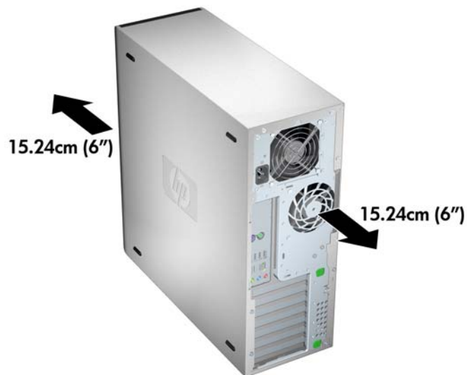
Obrázek 3-1 Správné větrání pracovní stanice
