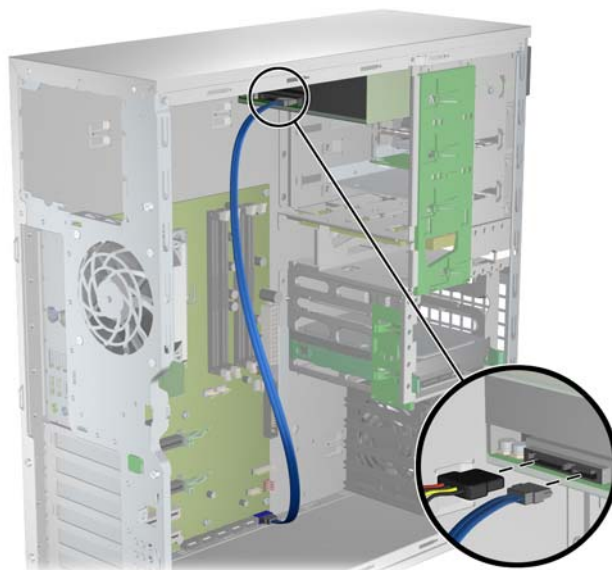
Obrázek 10-2 Připojení napájecích a datových kabelů ODD
