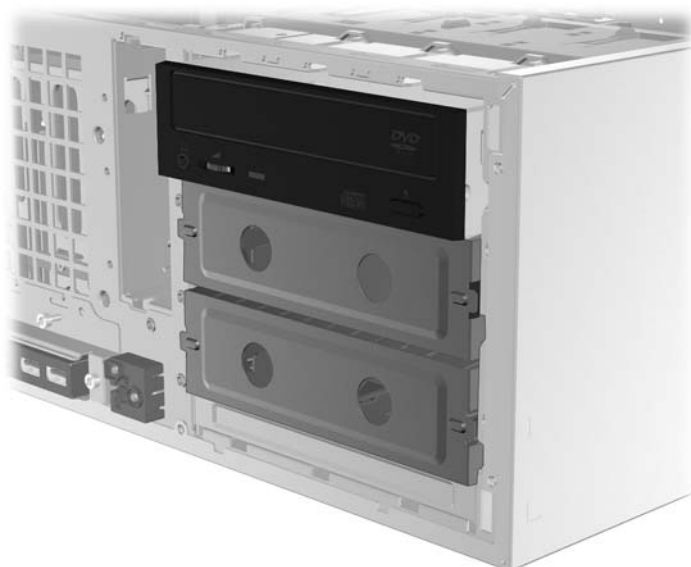
Obrázek 3-7 Opětovná instalace optické jednotky
