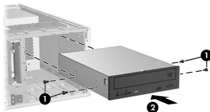
Obrázek 10-3 Instalace optické jednotky
