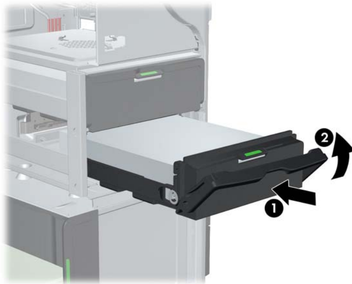
Obrázek 9-6 Instalace HDD do skříně
