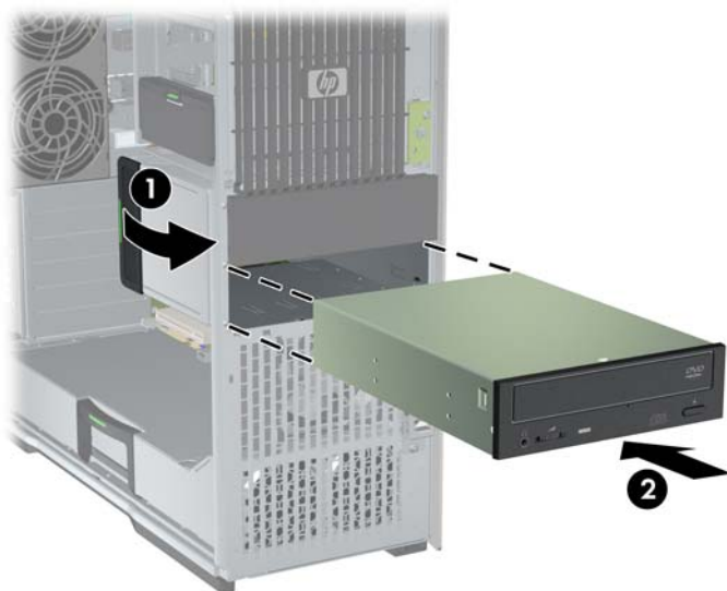
Obrázek 10-4 Instalace optické jednotky
