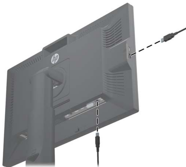
Obrázek 2-11 Připojení kabelů USB
