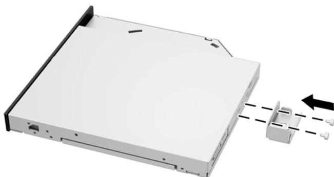
Obrázek 2-46 Připevnění držáku jednotky optického disku
