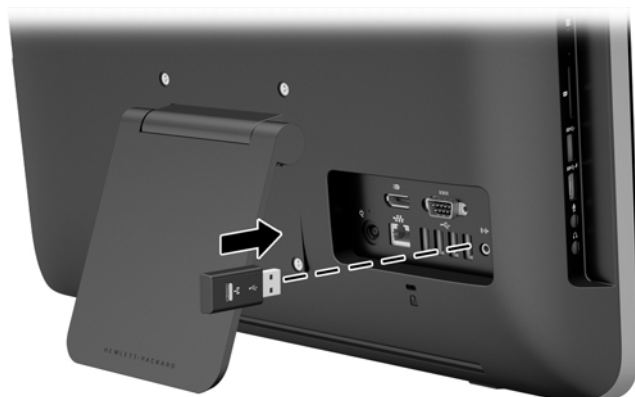
Obrázek 2-4 Instalace bezdrátového přijímače
