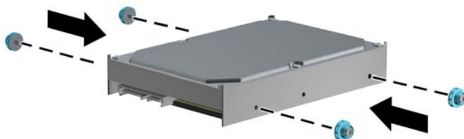
Obrázek 3-37 Montáž vodicích šroubů pevného disku
