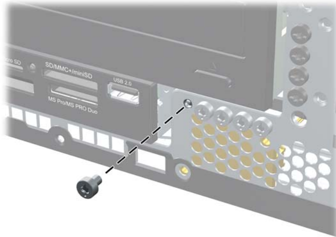
Obrázek 3-50 Nalezení bezpečnostního šroubu v čelním panelu
