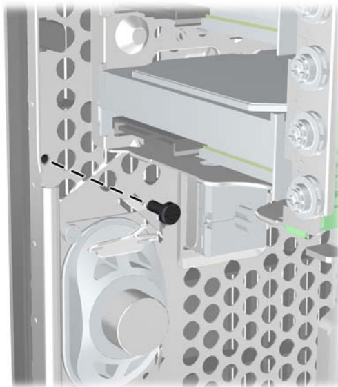
Obrázek 2-43 Instalace bezpečnostního šroubu čelního panelu
