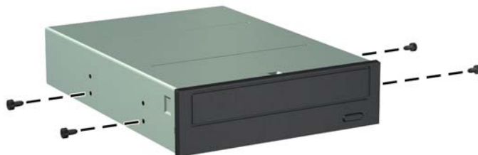
Obrázek 3-22 Zašroubování vodicích šroubů do optické jednotky
