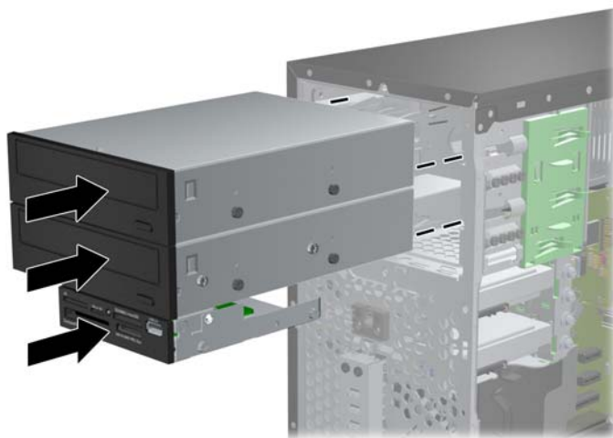
Obrázek 2-21 Zasunutí jednotky do modulu jednotek
