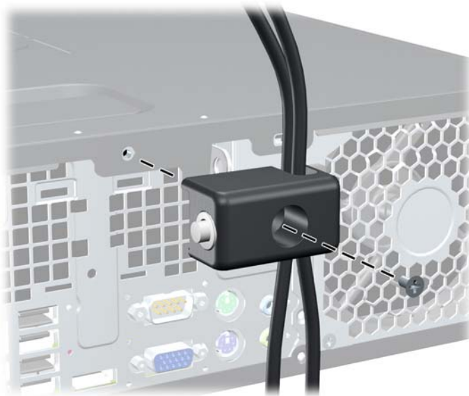
Obrázek 3-47 Připevnění zámku ke skříni
