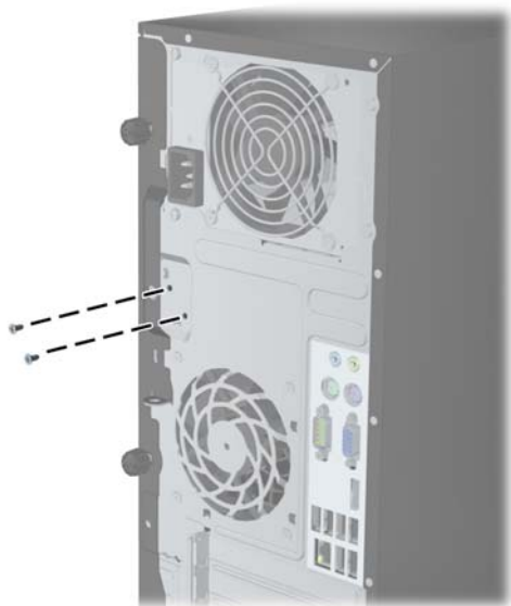
Obrázek C-2 Odšroubování šroubů chytrého zámku krytu z modelu Small Form Factor
