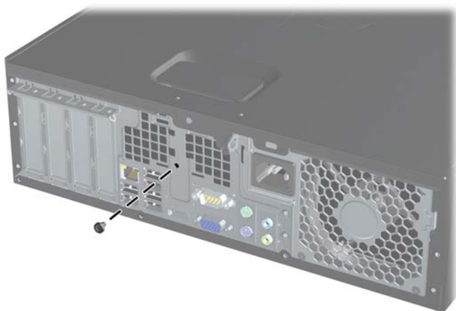
Obrázek C-2 Odšroubování šroubů chytrého zámku krytu z modelu Small Form Factor
