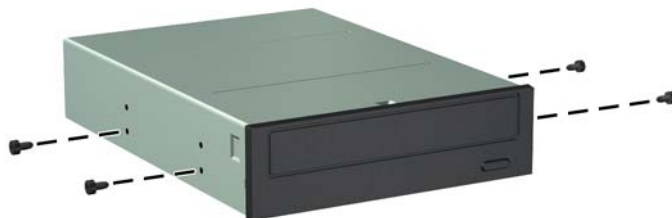
Obrázek 3-22 Instalace vodicích šroubů do optické jednotky
