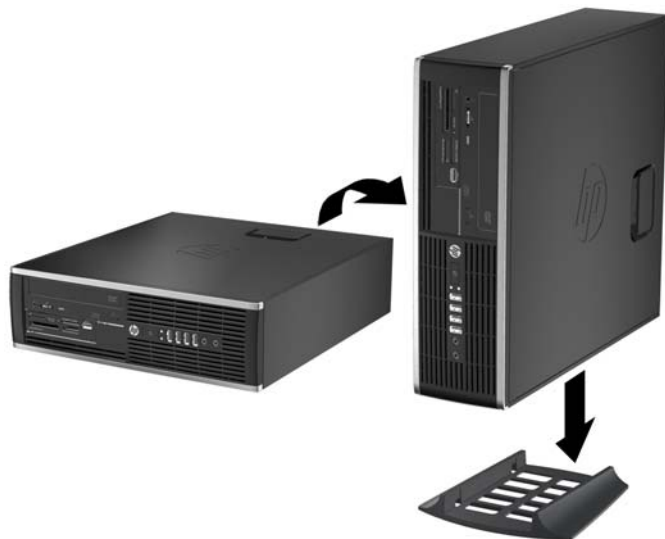
Obrázek 3-6 Změna orientace stolního počítače na typ tower
