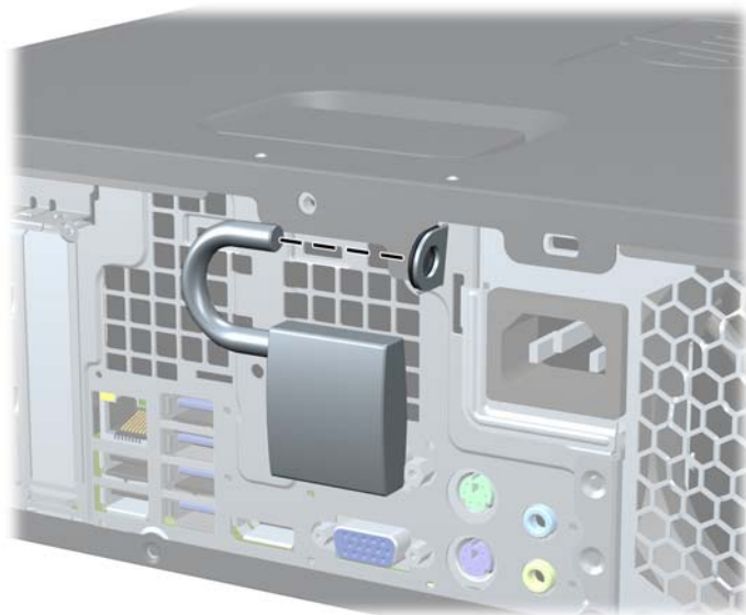
Obrázek 3-41 Instalace visacího zámku
