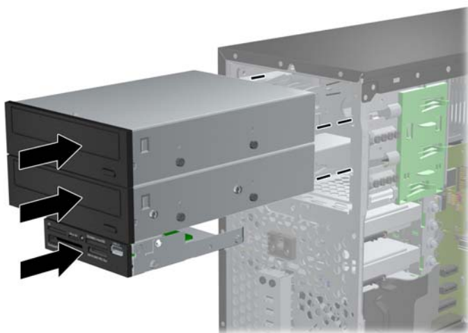
Obrázek 2-21 Zasunutí jednotky do modulu jednotek
