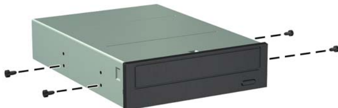
Obrázek 4-23 Instalace vodicích šroubů do optické jednotky (2 z 2)
