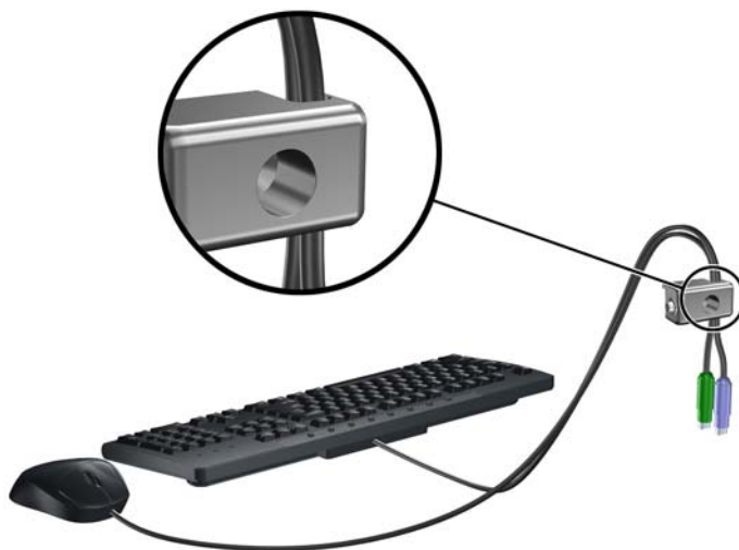
Obrázek 2-45 Protážení kabelů klávesnice a myši
