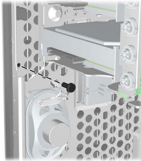
Obrázek 3-44 Instalace bezpečnostního šroubu čelního panelu
