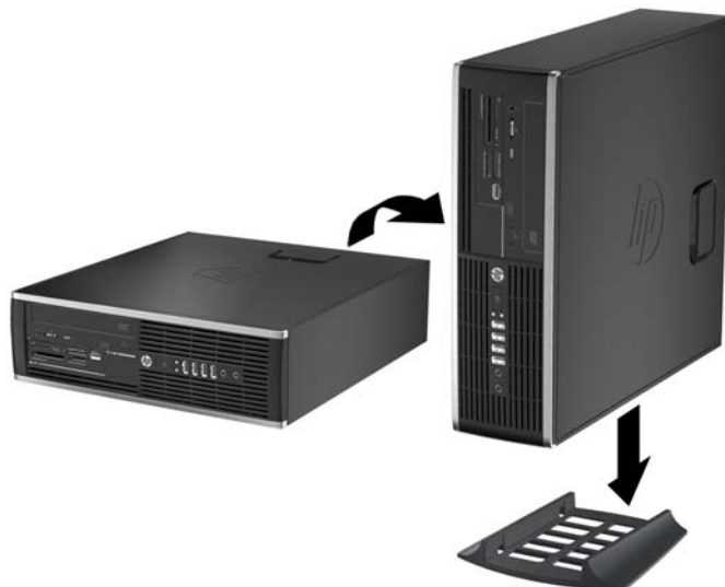
Obrázek 4-6 Změna orientace stolního počítače na typ tower
