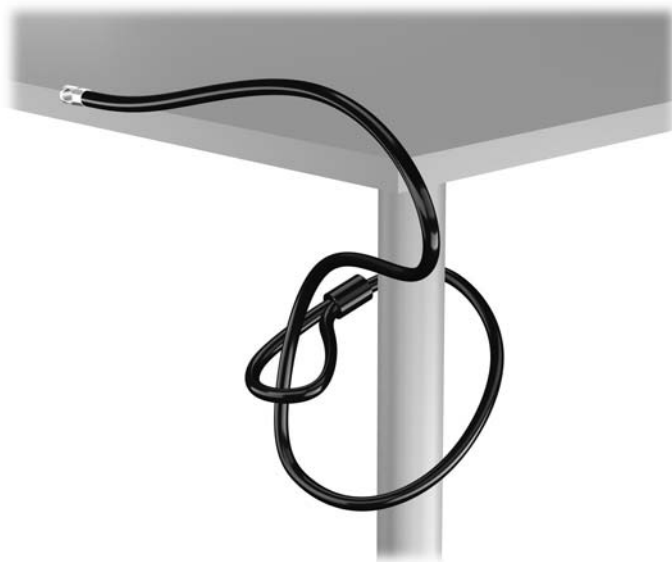
Obrázek 4-43 Připevnění kabelu k nepohyblivému předmětu
