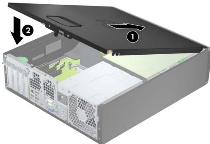
Obrázek 4-2 Nasazení krytu počítače
