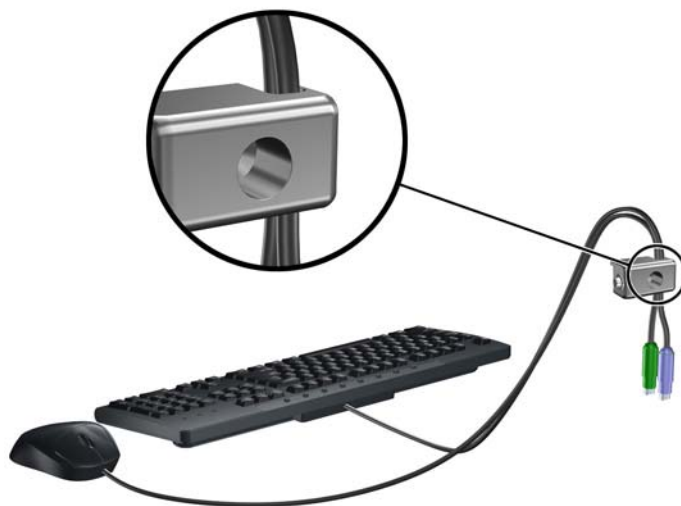
Obrázek 5-31 Provláčení kabelů klávesnice a myši zámek
