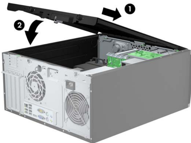
Obrázek 3-2 Nasazení krytu počítače
