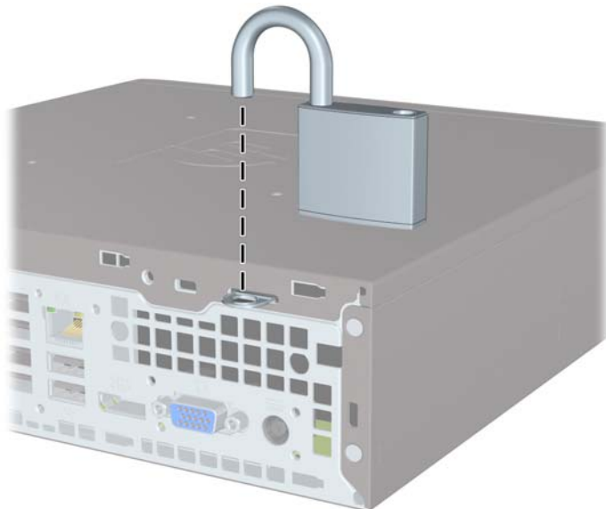
Obrázek 5-26 Instalace visacího zámku
