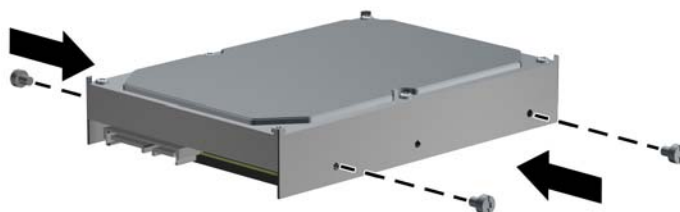
Obrázek 2-29 Použití běžných vodicích šroubů
