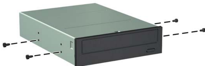
Obrázek 4-23 Instalace vodicích šroubů do optické jednotky (2 z 2)
