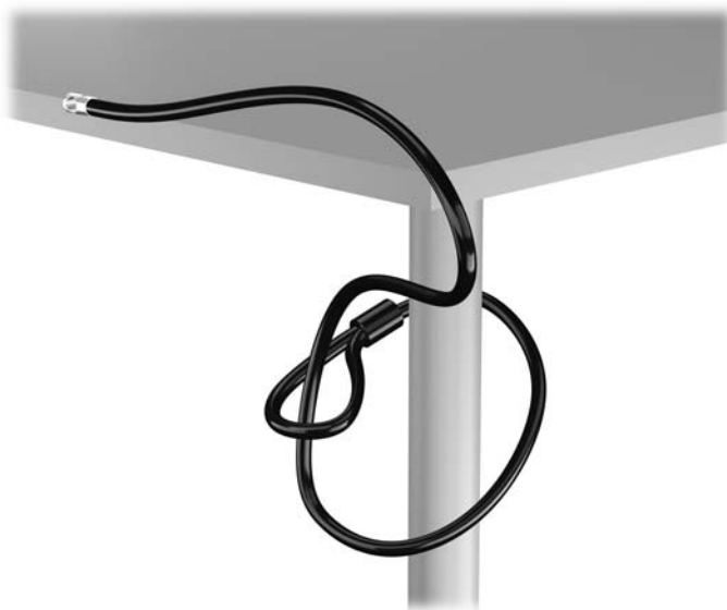
Obrázek 2-41 Připevnění kabelu k nepohyblivému objektu
